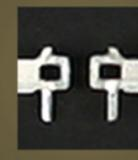
従来 エッチング → プレス代替 Press work substituted for Etching
